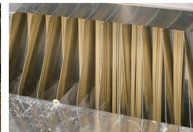
↑麺を切ると自動的に下の釜に落ち、1食分ずつゆで、すぐに5℃の冷水でしめます。打ちたて、ゆでたてのうちに冷凍へ。
