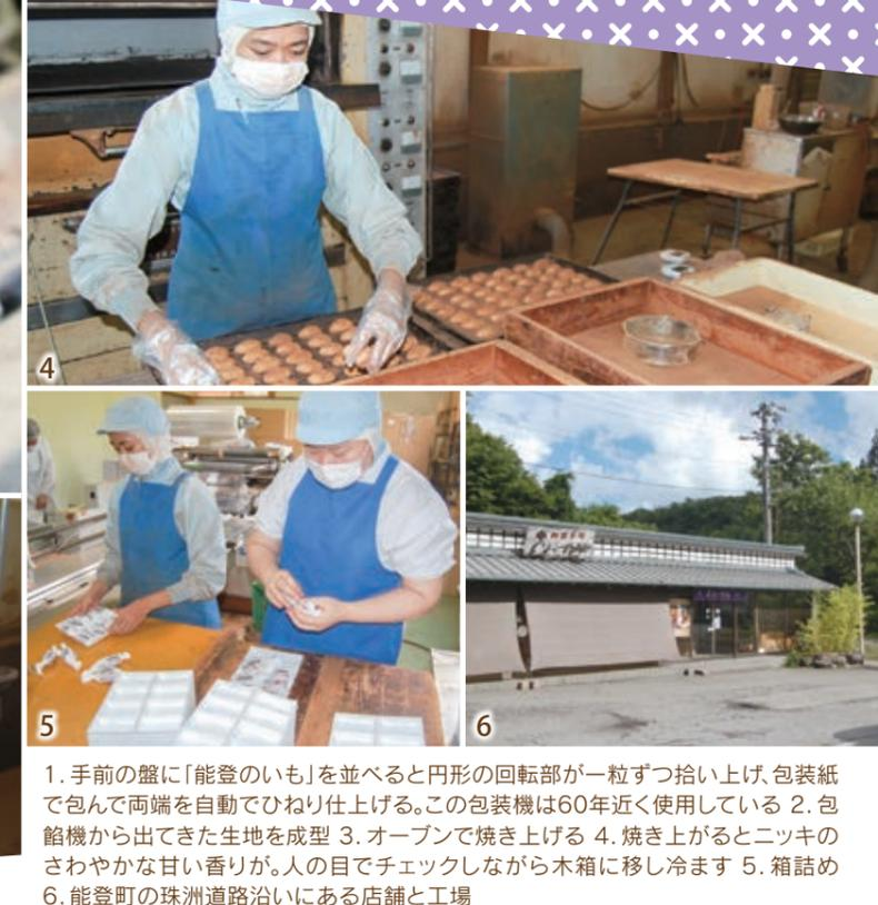
1. 手前の盤に「能登のいも」を並べると円形の回転部が一粒ずつ拾い上げ、包装紙で包んで両端を自動でひねり仕上げる。この包装機は60年近く使用している 2. 包餡機から出てきた生地を成型 3. オープンで焼き上げる 4. 焼き上がるとニッキのさわやかな甘い香りが。人の目でチェックしながら木箱に移し冷ます 5. 箱詰め 6. 能登町の珠洲道路沿いにある店舗と工場
