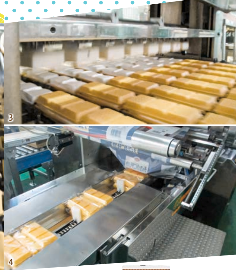
1. モナカ皮をセット 2. モナカ皮にチョコを流す 3. アイスをのせ、モナカ皮ではさむ 4. 急速冷凍で硬化し、包装 5. 「国産果汁を使ったみかんアイス」シャーベットの充填 6. フタをして急速冷凍 7. トレイに並べて包装
