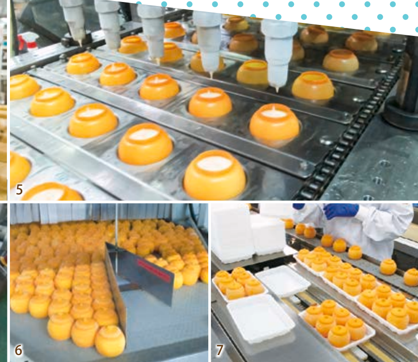
1. モナカ皮をセット 2. モナカ皮にチョコを流す 3. アイスをのせ、モナカ皮ではさむ 4. 急速冷凍で硬化し、包装 5. 「国産果汁を使ったみかんアイス」シャーベットの充填 6. フタをして急速冷凍 7. トレイに並べて包装
