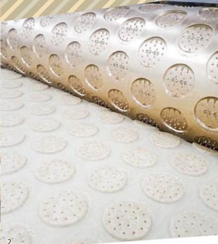
1.網コンベアの下からチョコレートが付けられる 2.シート状の生地はローラーで型抜き 3.原料の小麦は北海道産100% 4.ビスケット面にはCO・OPマーク 5.チョコ付けされたビスケットはチョコ面を上にして落ち、冷却される
