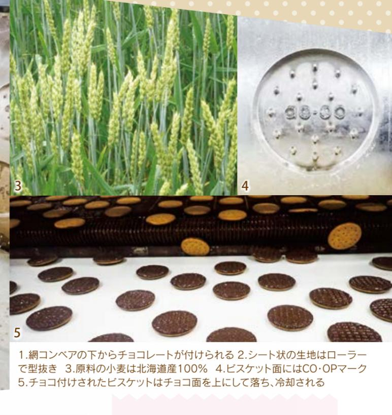
1. 網コンベアの下からチョコレートが付けられる 2. シート状の生地はローラーで型抜き 3. 原料の小麦は北海道産100% 4. ビスケット面にはCO・OPマーク 5. チョコ付けされたビスケットはチョコ面を上にして落ち、冷却される
