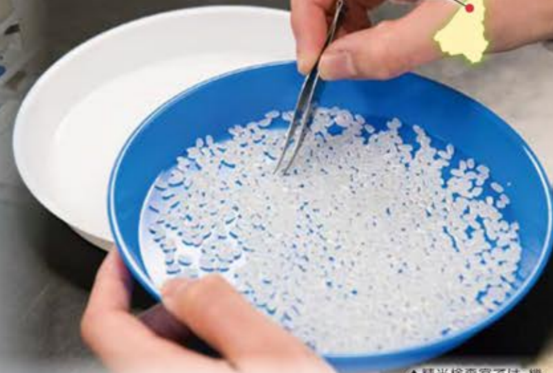
▲精米検査室では、機械分析の他、手分析や官能検査、実際に炊飯して行う食味試験などを通して品質やおいしさを監視と維持に努めています。
