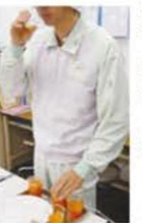
なく、いったんゆることでえぐみが少なくなります。やかになるのです。搾汁後、濃縮して冷凍保管。ミックスキャロット製造時には必要な分を解凍し、7種の果汁をブレンドします。できあがったジュースは糖度、酸度、pHなどを機械等で検査するだけでなく、人の舌と目で確認する「官能検査」を行います。社内認定制度に合格した社員が味や風味などをチェックし、機械では検出できないわずかな変化を見逃さず品質を確かめます。
