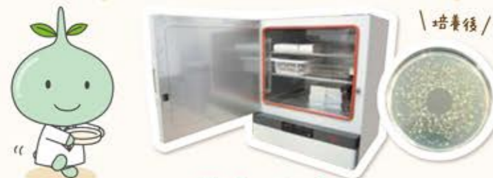
インキュベーター 細菌の培養に最適な時間・温度設定にできる機械
