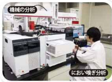
においの分析機械を使った検査の様子 「機械による成分分析と人によるにおい嗅ぎ分析」を同時に行います。
